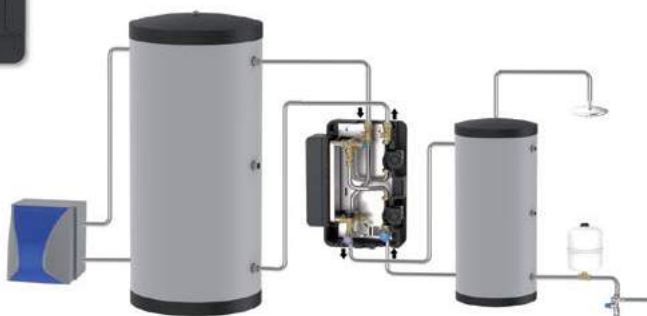
akumulačná nádoba vykurovacej vody
