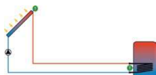
Vnútorný výmenník tepla, logika čerpadla
